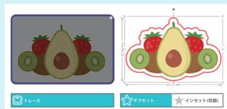
利用现有的图像就可以简单地制作切割数据。通过提取轮廓线，再配合偏移功能，就能作成带有留白区域的数据。
